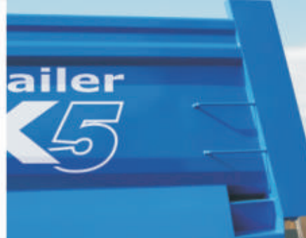
Pilar traseiro inclinado e escada lateral
