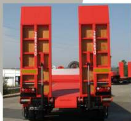
Rampas traseiras (2) movidas através de cilindros hidráulicos, com deslocamento lateral hidráulico e comandadas por distribuidor hidráulico de alavancas
