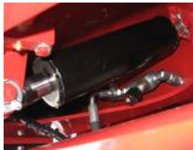
Ouverture et fermeture des crochets de la porte par vérin hydraulique en option
