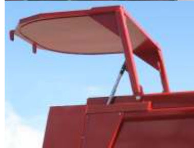
Porte arrière inclinée à ouverture hydraulique en option
