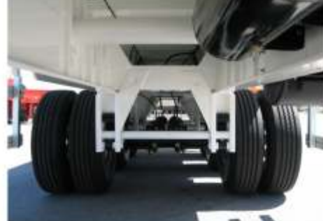
Suspension mécanique tridem renforcée avec ressorts semi-elliptiques.
