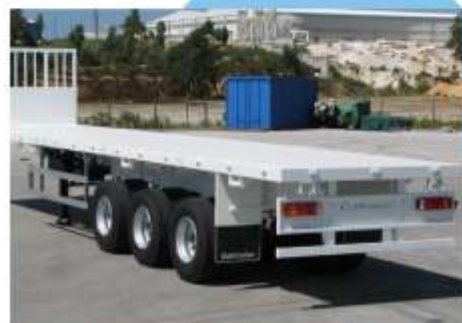
12 Twist locks pour conteneurs (1-40°, 2-20°, 1-20° centré) montés dans des bras tubulaires renforcés, moulinsets et garde-boue en acier
