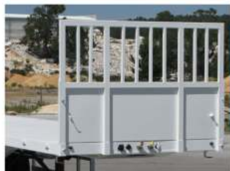
Hayon frontal renforcé et facilement démontable
